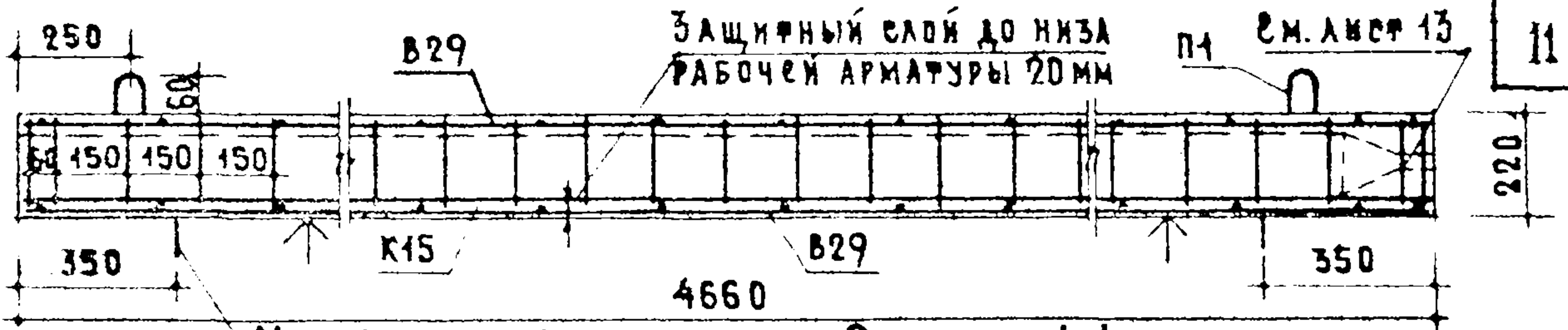
Места опирания при складировании и транспортировке РАЗРЕЗ 1-1
